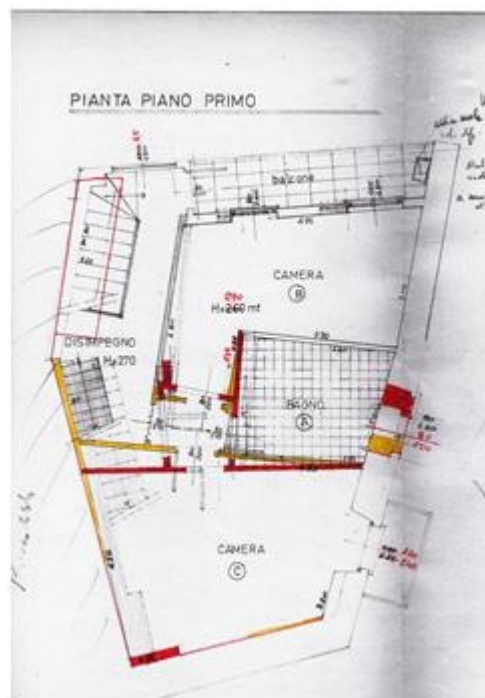
difformità piano primo
